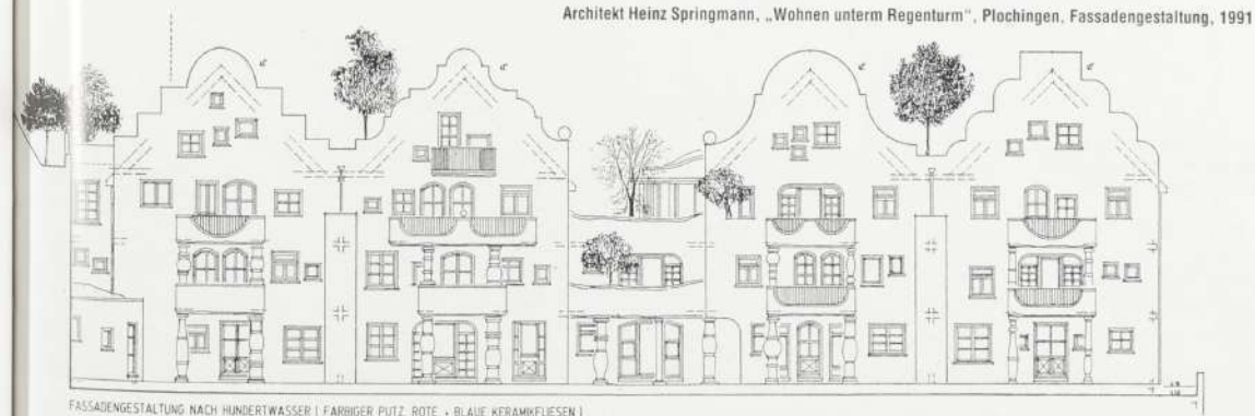
FASSADENGESTALTUNG NACH HUNDETTWASSER | FARBIGER PUTZ, ROTE - BLAUE KERAMIKFLIESEN |
