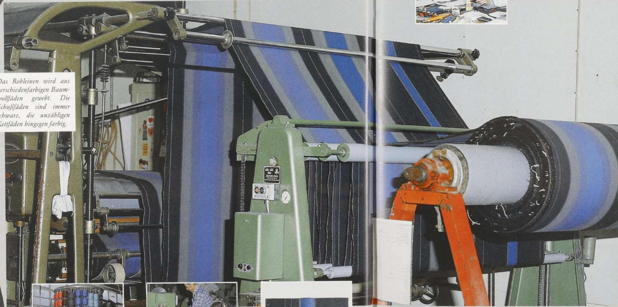
Das Rohleinen wird aus verschiedenfarbigen Baumwollfäden gewebt. Die Schußfäden sind immer schwarz, die unzähligen Kettfäden hingegen farbig.
