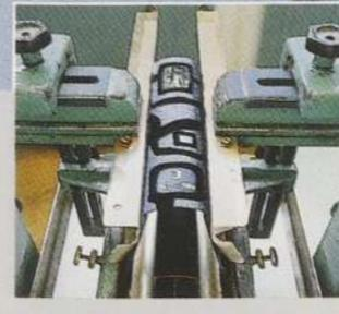
Gleich wird der Buchblock behutsam in die Buchdecke eingehängt, so daß der Einband mit der Veloursbeschichtung nicht beschädigt wird.
