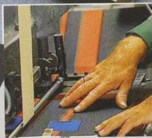
Die Applikation der auf Aluminiumbasis metallisierten Folien erfordert besondere Präzision. Sie können mit der Zeit korrodieren – ähnlich venezianischen Spiegeln.
